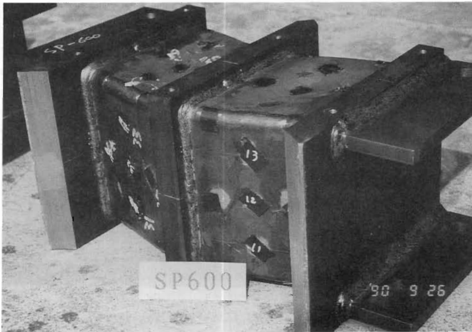
写真 5.1 パネルの破壊状況 ( SP 600 )
