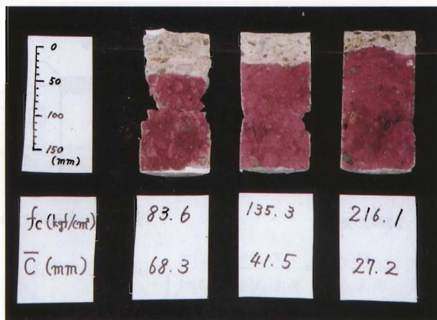
写真 5.1 中性化深さ測定結果の一例
