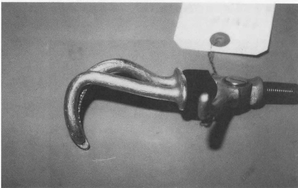
図7.4 先端にずれが生じたフック
