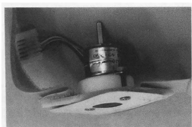
図6.35 把持力の断端へのフィードバック装置
