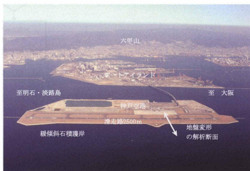
写真- 2.1 変形解析対象護岸断面位置
