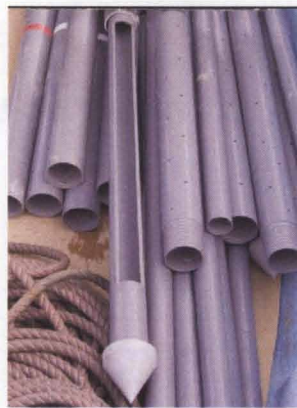
写真- 5.1 貫入型原位置採泥器
