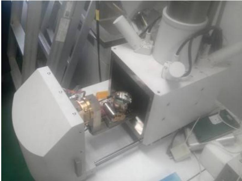
図 6.7 SEM (走査型電子顕微鏡)
