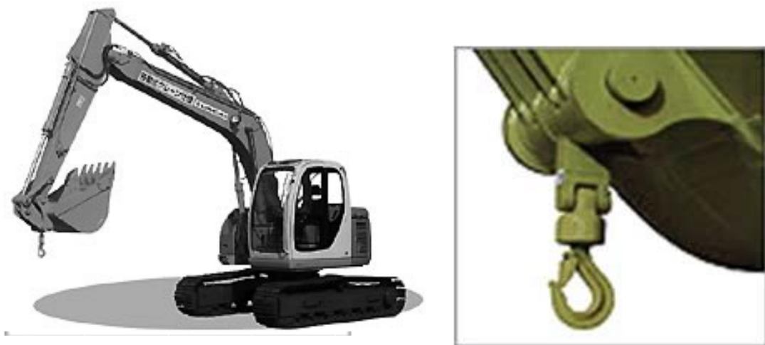
(a) クレーンフックの付いた油圧ショベル (b) バケット部分の拡大図
