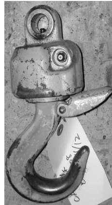
(a) クレーンフックの見本 (b) 損傷したクレーンフック 図 3.2 典型的なクレーンフックと損傷したクレーンフックの見本
