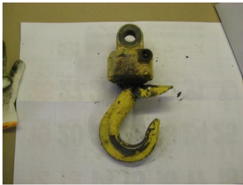
図 3.17 損傷したフックの画像及び推定した荷重条件 (3 例の内 3 例目)
