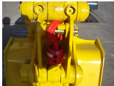
図 1.4 クレーン車に取り付けられたフックと油圧ショベルに取り付けられたフック
