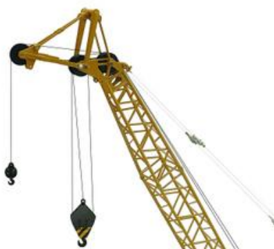
図 1.4 クレーン車に取り付けられたフックと油圧ショベルに取り付けられたフック
