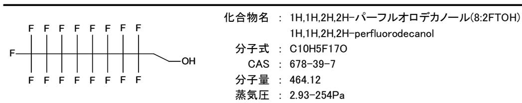
図 4-4 8:2-FTOH の構造式及び物理化学的特性
