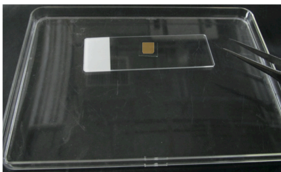
Fig. 5-1 イメージングマス (IMS) プレーットの作成 (オレンジで示した部分に粘着剤を塗布)
