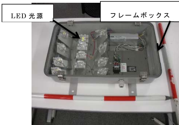
写真-6.1 標準的なトンネル照明器具
