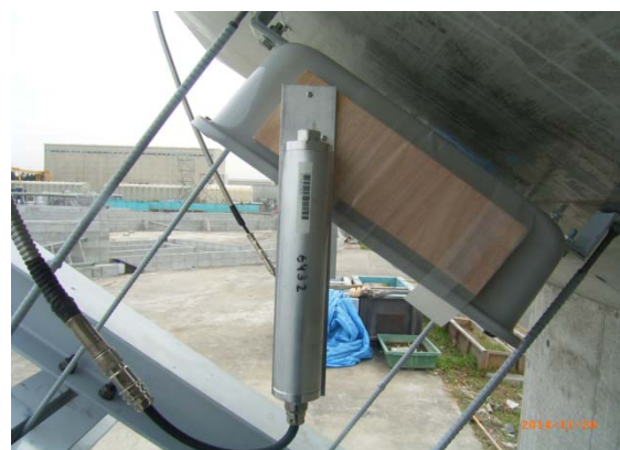
写真-6.3 傾斜センサー (IT孔内傾斜計)
