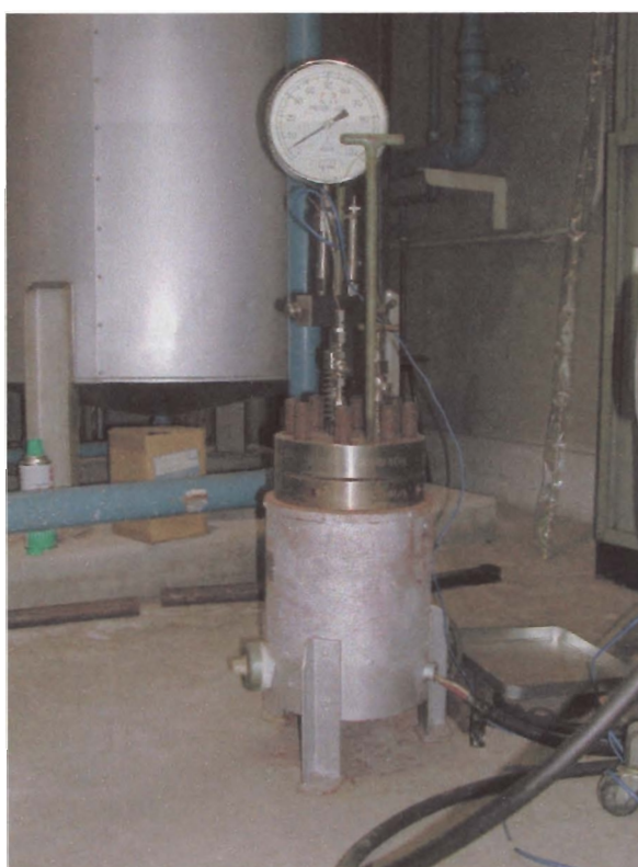
図 10.2 ボイラ水中の Mg 硬度の挙動調査の実験 (第5章の実験装置)
